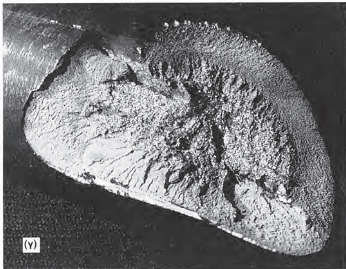
Σχήμα 3.5 : (α) Μορφή επιφάνειας θραύσης από κόπωση (A: θέση έναρξης ρωγμής, B: επιφάνεια διάδοσης της ρωγμής λόγω της κόπωσης και Γ: επιφάνεια τελικής θραύσης). (β) Επιφάνεια θραύσης στροφαλοφόρου άξονα λόγω κόπωσης και (γ) επιφάνεια θραύσης χαλύβδινου άξονα, λόγω έντονης στρεπτικής κόπωσης.
